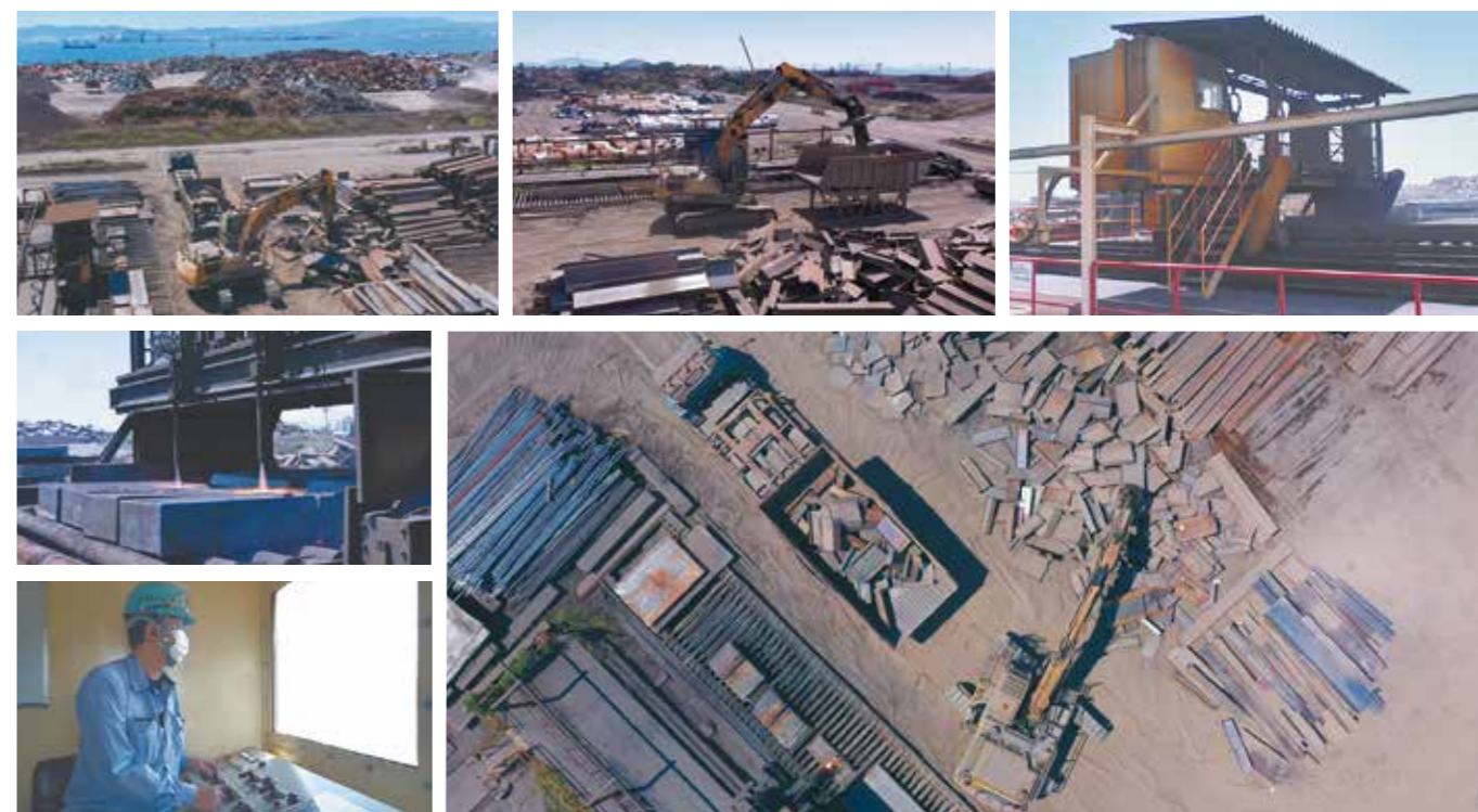
業務内容 ●場内発生スクラップ受け入れ（丸棒 厚板 コイル H型钢） ●品種別、選別作業（マーキング） ●場内発生スクラップ切断作業 ●切断品 積込み出荷作業 ●レンガ屑・地金屑 選別作業 ●レンガ屑・地金屑 出荷作業
